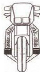
Slika br. 7. Model sigurnosnog motocikla opremljenog sa bočnim branikom (metlani branik) radi zaštite donjih ekstremiteta[6].
